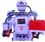
Jetzt steuern wir die Motoren an. Der Projekt-Explorer zeigt uns an, dass es im lejos.nxt - Verzeichnis eine Klasse regulatedMotor gibt. Diese hat eine Methode „setSpeed()“. Das hört sich in meinen Ohren sehr gut an. Motoren sprechen wir über folgendes Schema an: Motor.Portnummer.Methode.
